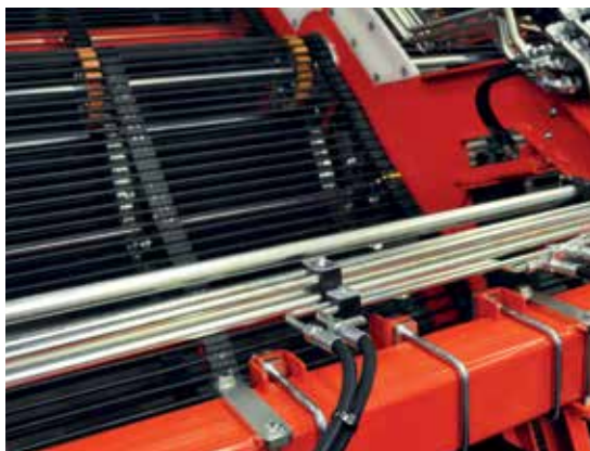
Uso máximo de tubos = sin roces entre conductos
