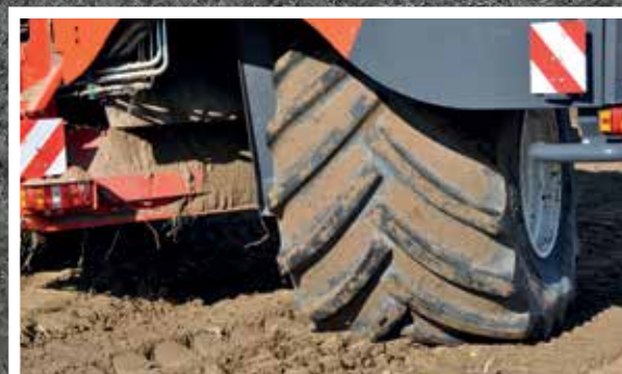
Rueda trasera extra ancha opcional (1250/50 R32) con una presión de neumáticos de 1,4 bar.
