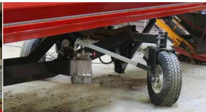
ПОВОРОТНЫЕ КОЛЕСА С ПНЕВМАТИЧЕСКИМИ ШИНАМИ (MC DUO & TAT)
