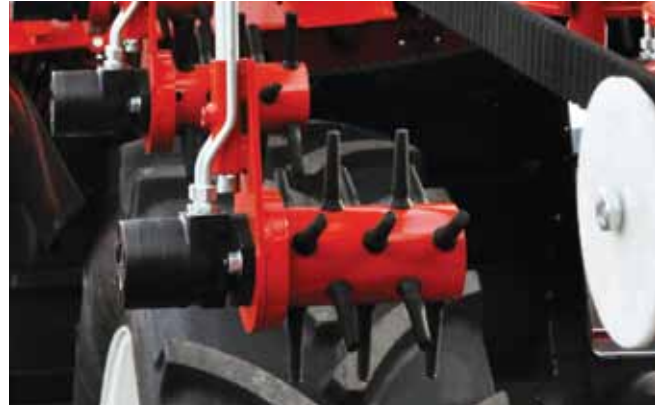
Hydraulisch aangedreven roterende reinigers indien intensievere reiniging gewenst is. (optie)
