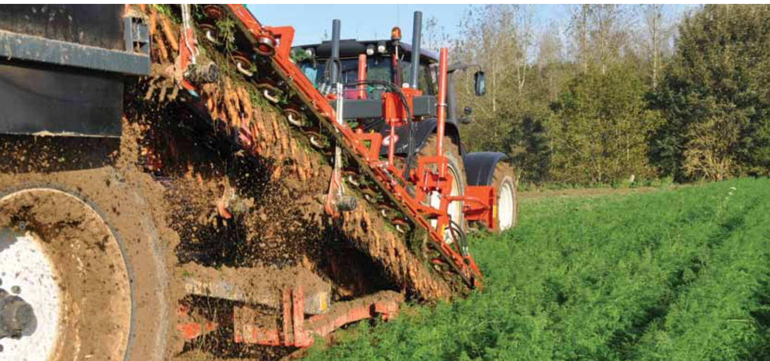
Via 1 handgreep per element kunnen alle ondersteunende riemschijven van een element aangespannd of gelost worden. Hierdoor wordt het vervangen van de riemen of het verwijderen van blokkages een stuk gemakkelijker. (optie)
