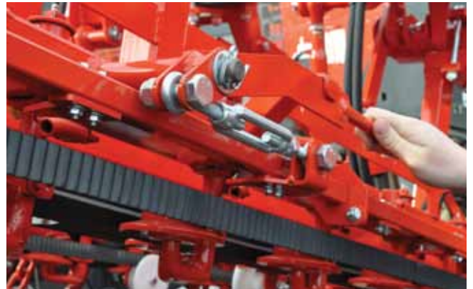
Via 1 handgreep per element kunnen alle ondersteunende riemschijven van een element aangespannd of gelost worden. Hierdoor wordt het vervangen van de riemen of het verwijderen van blokkages een stuk gemakkelijker. (optie)
