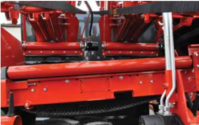
Rollen voor (optie), onder en na de messen (standaard) beperken verliezen en opstopningen tot een minimum.
