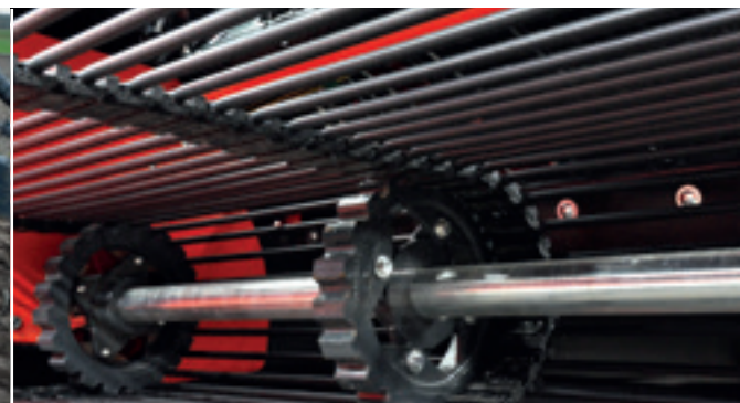
1-й ПРОСЕИВАЮЩИЙ ТРАНСПОРТЕР С ГИДРАВЛИЧЕСКИМ ПРИВОДОМ
