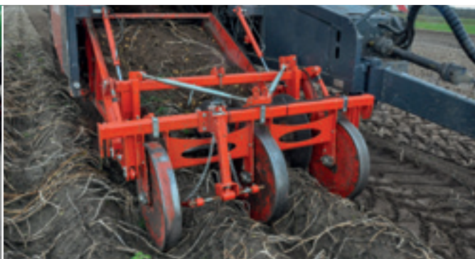
КОМПЛЕКТ ДЛЯ УБОРКИ КАРТОФЕЛЯ, СОДЕРЖАЩИЙ ДИСКОВЫЕ НОЖИ С ПРИВОДОМ
