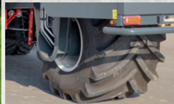
Superbreed achterwiel (1250/50 R32) met een bandenspanning van 0,9 bar.
